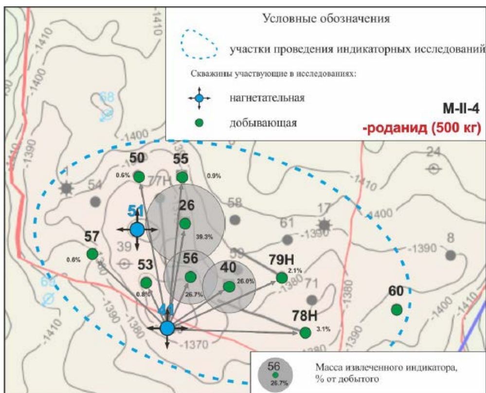
Рисунок 3.1.15 - Схема выхода извлеченного индикатора роданида на участке нагнетательной скважины №41
