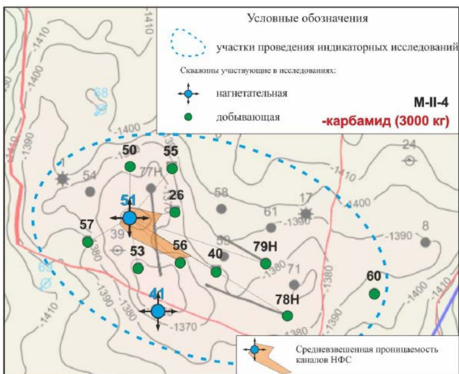
Рисунок 3.1.18 - Роза-диаграмма распределения средневзвешенных по массе проницаемостей канала участка нагнетательной скважины №51
