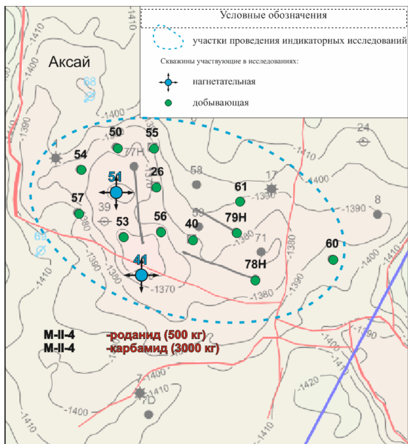
Рисунок 3.1.11 - Схема расположения скважин на участке нагнетательных скважин №№41, 51 во II этапе трассерных исследований
