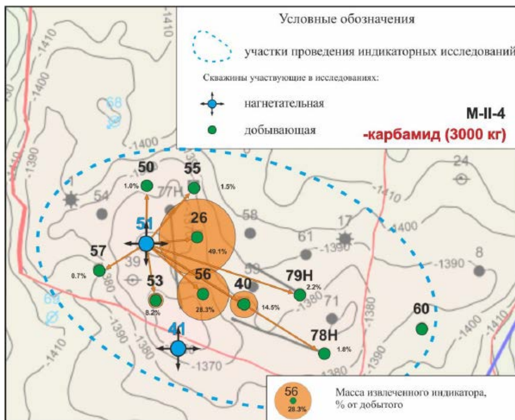
Рисунок 3.1.19 - Схема выхода извлеченного индикатора карбамида на участке нагнетательной скважины №51
