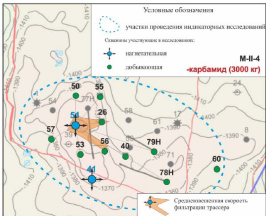
Рисунок 3.1.17 - Роза-диаграмма распределения средневзвешенных по массе скоростей фильтрации участка нагнетательной скважины №51
