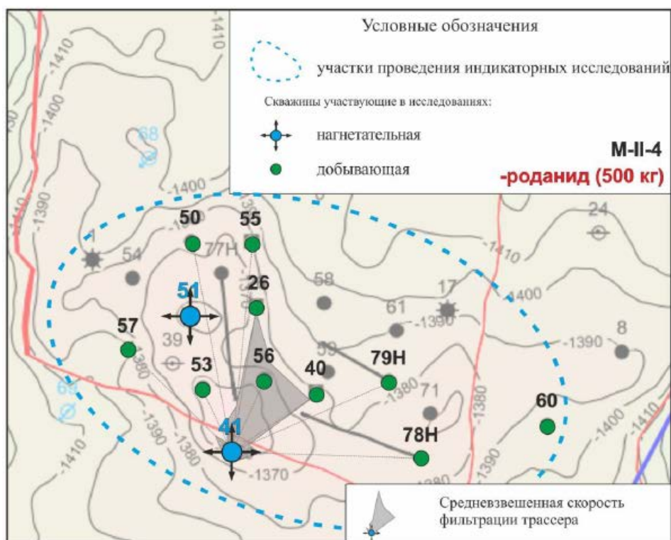
Рисунок 3.1.13 - Роза-диаграмма распределения средневзвешенных по массе скоростей фильтрации трассера участка нагнетательной скважины №41
